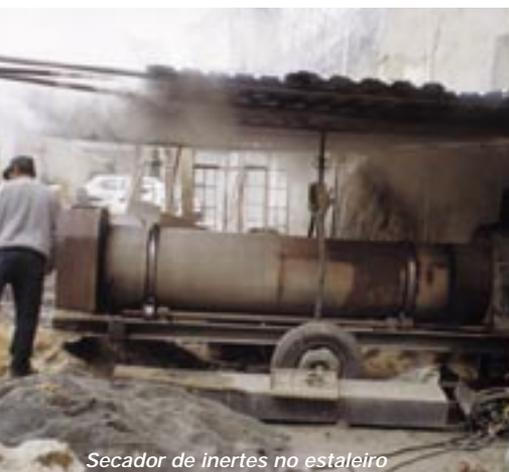
Secador de inertes no estaleiro
