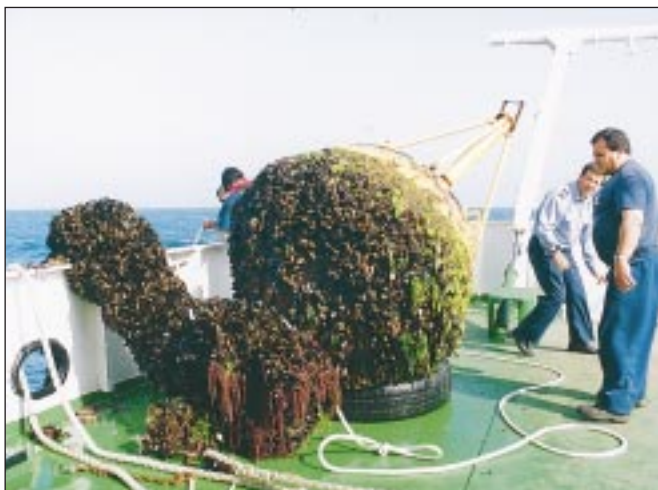
Bóia de protecção à bóia ODAS de Sines, antes de ser beneficiada
