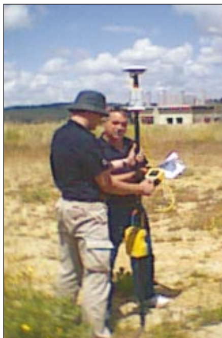
Fig. 2 – Verificação da exactidão do posicionamento
