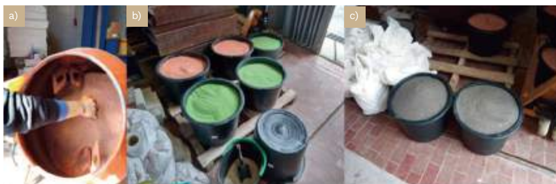
Figura 4 - Preparação dos traçadores: a) e b) fluorescentes laranja e verde; e c) magnéticos.
