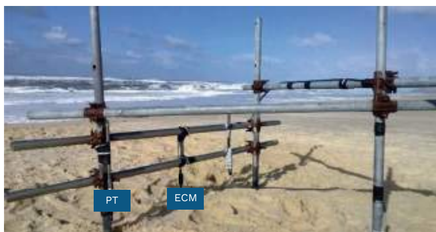
Figura 8 - Equipamentos de medição de parâmetros hidrodinâmicos colocados na praia emersa.
