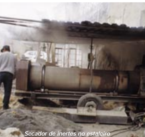
Secador de inertes no estaleiro
